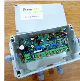
AFP Nano: Özel tek fonksiyonlar Modbus, RS485 haberleşme bağlantıları
